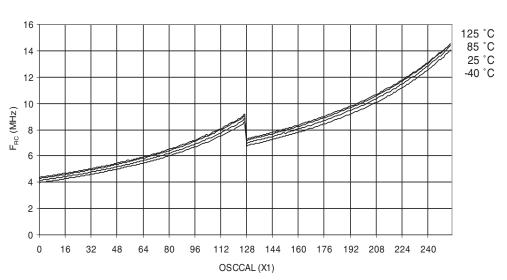
CALIBRATED 8.0MHz RC OSCILLATOR FREQUENCY vs. OSCCAL VALUE (Vcc=3V)
