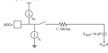
Figure 25-8. Analog Input Circuitry
