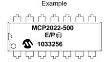
14-Lead SOIC (3.90 mm)
