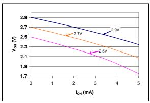
**FIGURE 2-23:** V<sub>OH</sub> vs. I<sub>OH</sub> (TC1270AT, TC1270ANT, TC1271AT - 3.00V min./3.08V typ./3.15V max.) @ +25°C).
