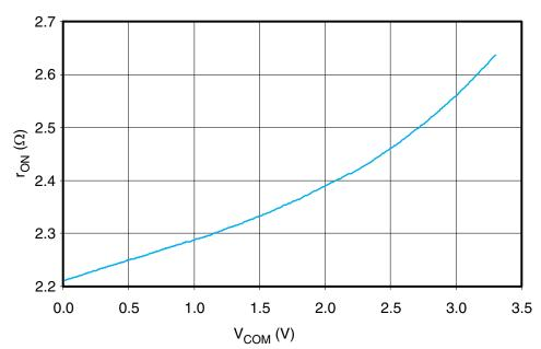
Figure 4. .  $r_{ON}(\Omega)$  vs  $V_{COM}(V)$
