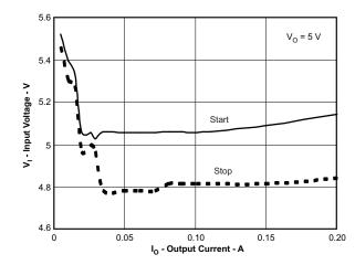
Figure 27. 5-V Start/Stop Voltage
