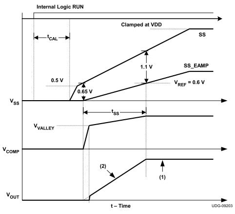
Figure 22. Soft-Start Waveforms
