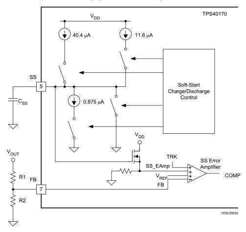
Figure 21. Soft-Start Schematic Block
