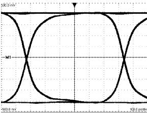
Figure 8. 1.5 Gbps Differential DS15BA101 Output  $R_{VO}$  = 953 $\Omega$ , H:100 ps / DIV, V:100 mV / DIV
