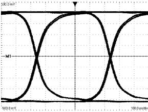
Figure 10. 2.0 Gbps Differential DS15BA101 Output  $R_{VO}$  = 953  $\Omega_{\rm l}$  H:100 ps / DIV, V:100 mV / DIV
