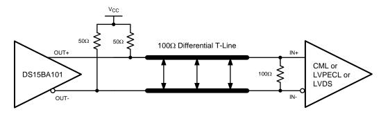
Figure 5. Typical DS15BA101 Output DC-Coupled Interface to an LVDS, CML or LVPECL Receiver
