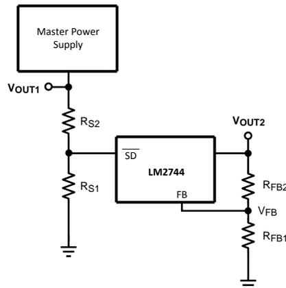
**Figure 24. Sequencing Circuit**
